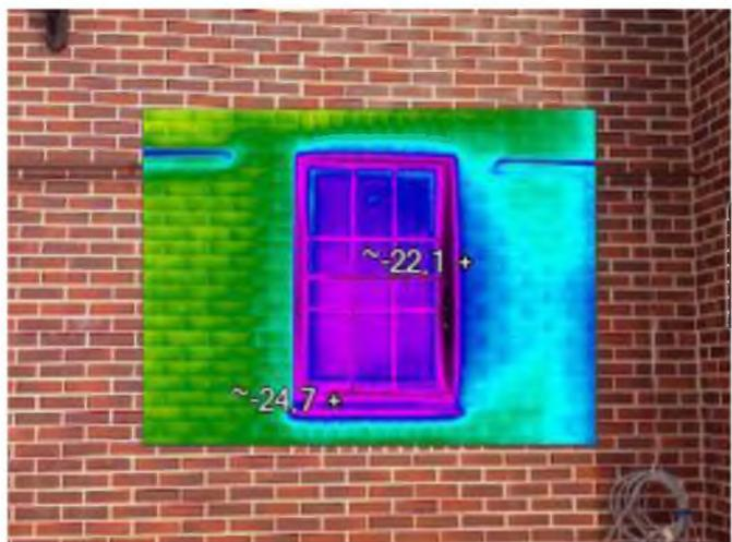
Рис.9 (Пример оптимального распределения тепловых полей)
